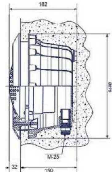
Detalj ugradnje u zidu bazena
