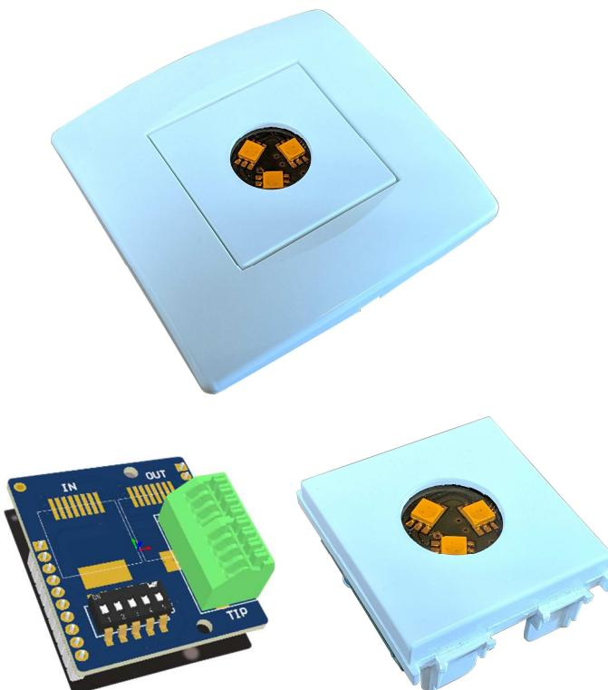
ESM je modul namijenjen pozivanju iz invalidskog WC-a ili za slične prostore gdje je potrebna ovakva signalizacija. Korisnik putem pozivnog tipkala, npr. potezno tipkalo, aktivira zvučni i svjetlosni alarm na ESM-u. Alarm se poništi tipkalom namijenjenim za poništenje. Način rada je podesiv putem prekidača na uređaju i može poslužiti i kao pozivni uređaj za ordinacije.
