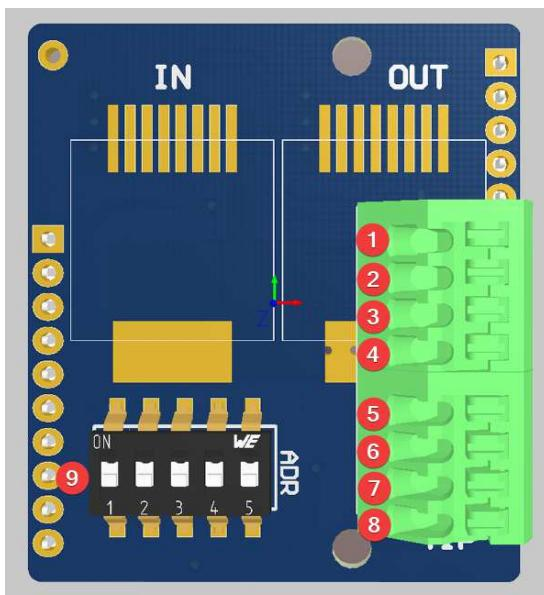
Priklučni terminal za spajanje tipkala i napajanja :
